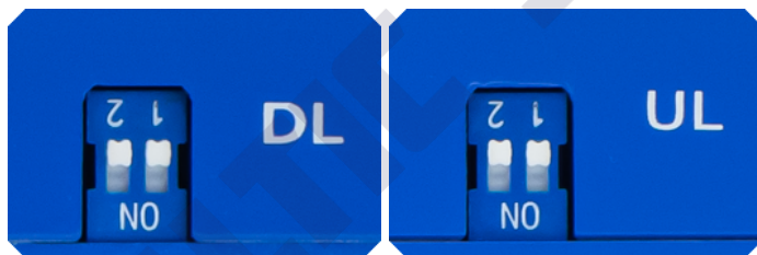
Ручная регулировка усиления. Положение «вверх» — выключено, положение «вниз» — включено
