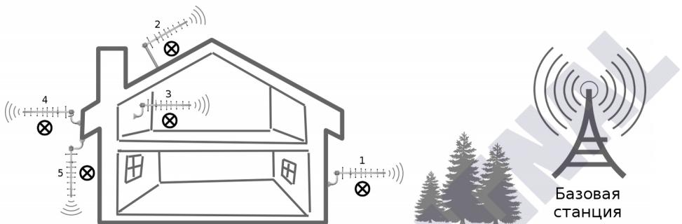
**1** — если на пути распространения сигнала располагаются препятствия (деревья, здания, возвышенности и т. п.), рекомендуется поднять антенну на более высокую точку. В противном случае качество связи может оказаться хуже из-за потерь сигнала при прохождении сквозь препятствия.
