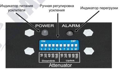
Ручная регулировка усиления. Положение рычажков «вверх» — включено, положение «вниз» — выключено
